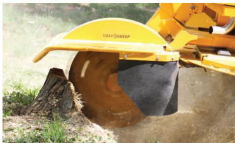
**PATENTIERTES SMARTSWEEP™ STEUERSYSTEM.** Das patentierte SmartSweep™ Steuersystem reguliert die Fräsgeschwindigkeit während des Betriebs automatisch, wodurch der Verschleiß am Motor und Antriebsstrang reduziert und die Produktivität erhöht wird.
