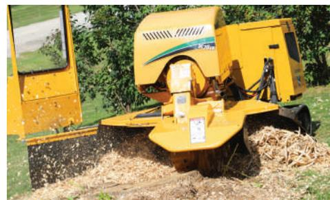
**YELLOW JACKET™ FRÄSZAHNSYSTEM.** Das Yellow Jacket™ Fräszahnsystem garantiert einen schnellen, einfachen Service und eine lange Lebenszeit der Zähne und Halter.
