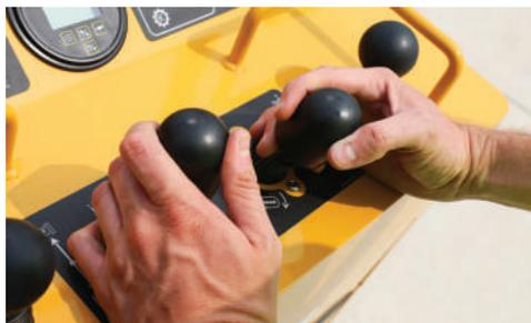
**BEDIENSICHERHEITSSYSTEM (TOTMANSCHALTUNG).** Dieses benutzerfreundliche Sicherheitssystem schützt den Bediener und erhöht die Sicherheit. Sobald die Hände des Bedieners die Steuerhebel länger als eine Sekunde verlassen, aktiviert sich die Totmannschaltung und das Fräsrad stoppt.
