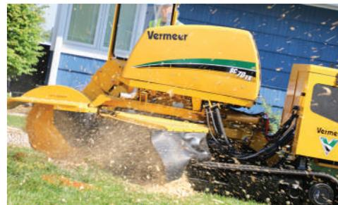
**EFFIZIENTES FRÄSEN.** Mit einem 50 kW (67 PS) CAT C2.2L Tier 4f (Stufe IIIB) Turbodieselmotor erfüllt die SC70TX die geltenden Emissionsbedingungen und erzielt die optimale Leistung für die erforderlichen Fräsarbeiten.
